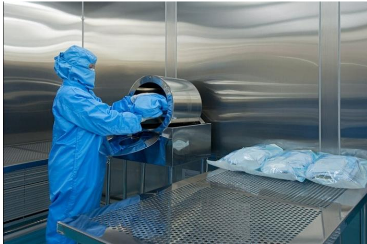
Teste de contagem de partícula em tambor – Helmke Drum Test.
