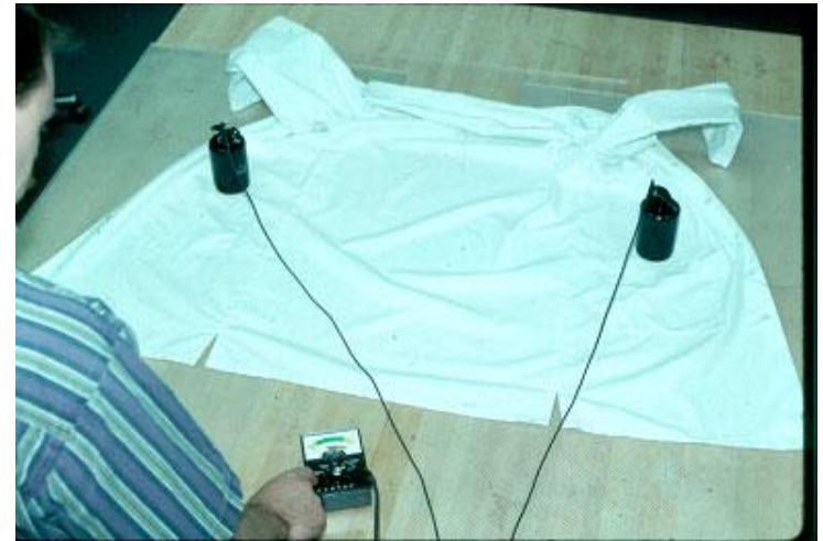
Teste de condutividade – ESD Test.
