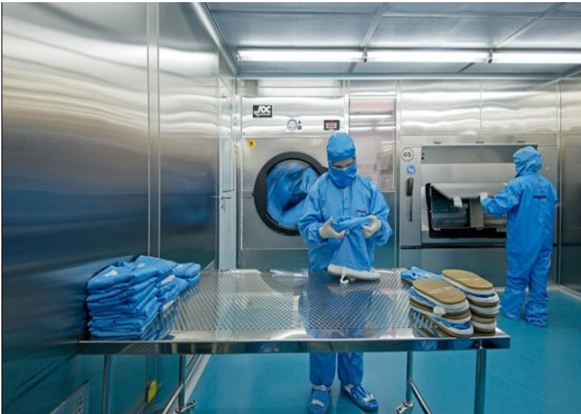
Secagem e manipulação de peças em ambiente controlado.
