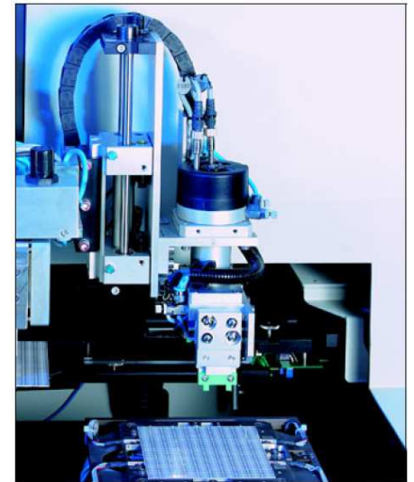
Abbildung 12: Laserabgleich der Platin-Chip-Temperatursensoren
