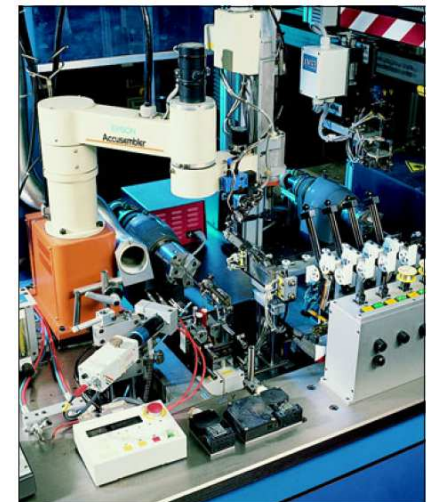
Abbildung 9: Automatisierte Produktion drahtgewickelter Platin-Glas-Temperatur-sensoren
