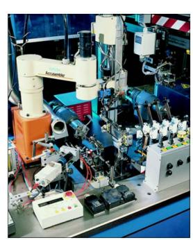
Abbildung 9: Automatisierte Produktion drahtgewickelter Platin-Glas-Temperatursensoren
