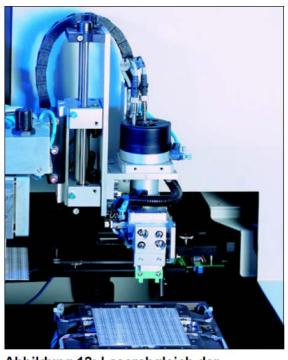
Abbildung 12: Laserabgleich der Platin-Chip-Temperatursensoren
