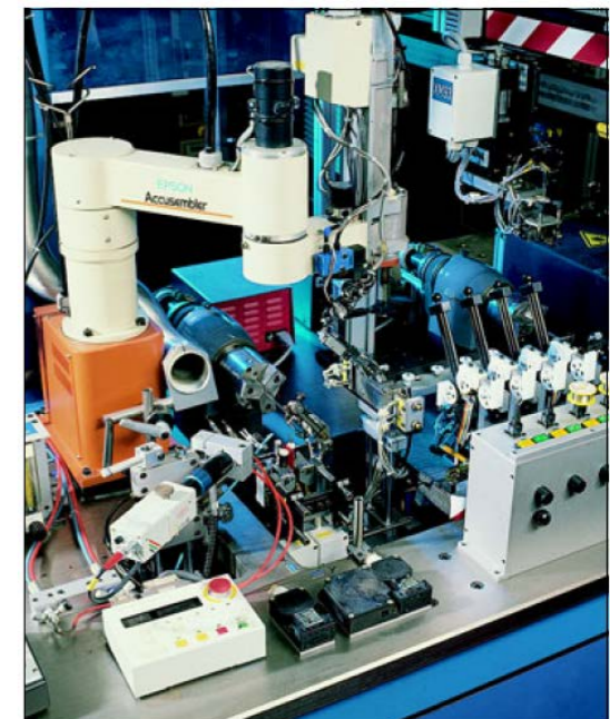
Abbildung 9: Automatisierte Produktion drahtgewickelter Platin-Glas-Temperatur-sensoren
