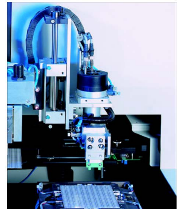
Abbildung 12: Laserabgleich der Platin-Chip-Temperatursensoren
