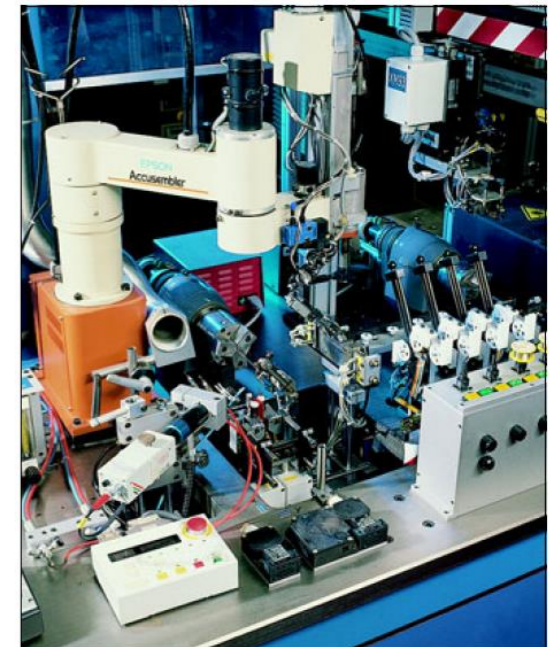
Abbildung 9: Automatisierte Produktion drahtgewickelter Platin-Glas-Temperatur-sensoren
