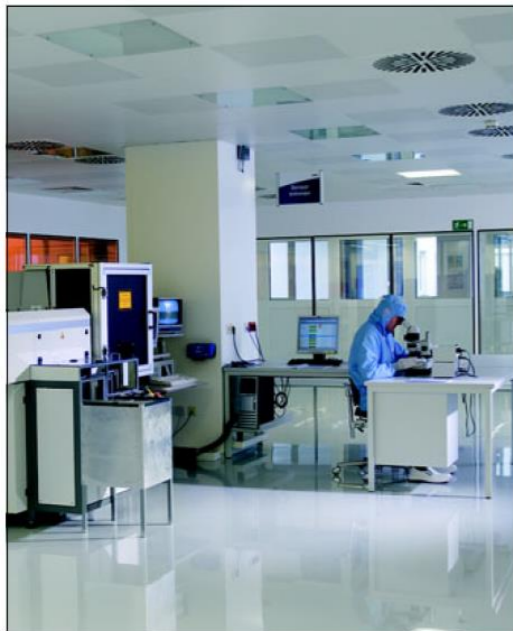
Abbildung 6: Temperatursensorproduktion unter Reinraumbedingungen
