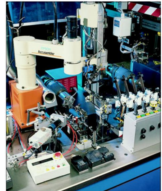
Abbildung 9: Automatisierte Produktion drahtgewickelter Platin-Glas-Temperatur-sensoren
